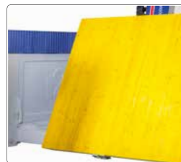
Piano di lavoro inclinabile idraulico Hydraulic tilting work table
