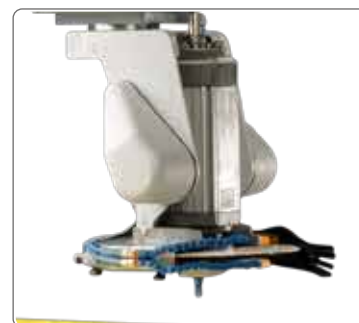
Inclinazione automatica della testa da 0° a 90° Automatic tilting head from 0° to 90°
