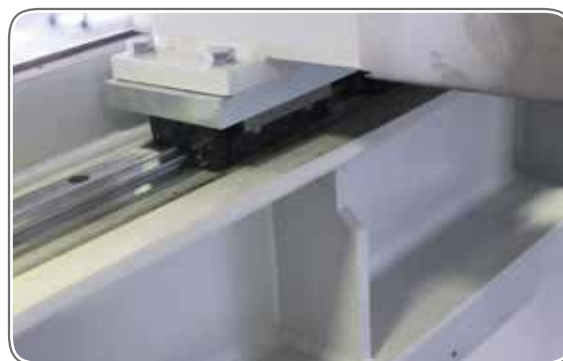
Guide lineari con pattini a ricircolo di sfere Linear guides with recirculating balls
