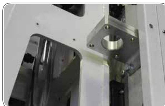
Struttura carro in acciaio elettrosaldato Carriage structure in electro-welded steel
